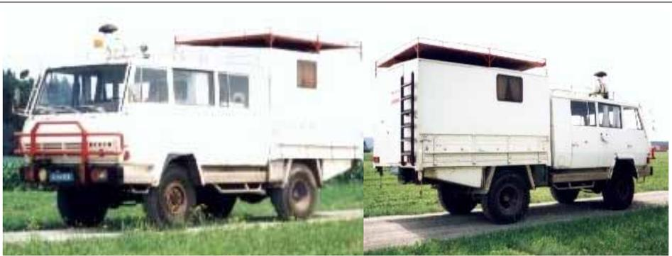
**Steyr 790 Allrad** 150 PS, 6-Liter-Turbo; ca. 90km/h; 15Gang-Getr. m. Unters., H.-Achssp.; 4t-Seilw.; 600l-Zus.Tanks; Schneeketten; Gasherd m. Flaschen; Standhgz. f. 16m<sup>3</sup>; 24V-Kühlschr.; Stahl-Sandbl.; zul. Ges. Gew. 15t; Leergew. ca. 10t; 300l-Wassertanks m. Katadynfilter; Kab. f. ca. 8 Pers., Durchgang hint. Wohnr. 70x60cm; Fliegengitter, Innenbel. Halogen 24 V, ca. 4 Schlafpl. umzub. in Sitzgruppe m. Tisch.
